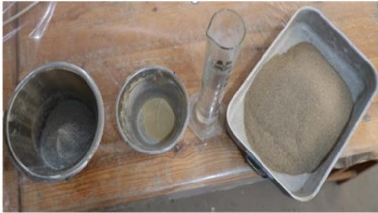
شكل (3) مكونات المونة الاسمنتية
