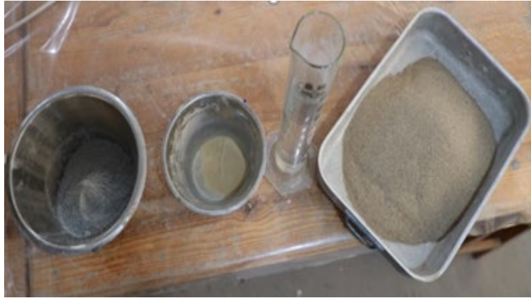
شكل (3) مكونات المونة الاسمنتية
