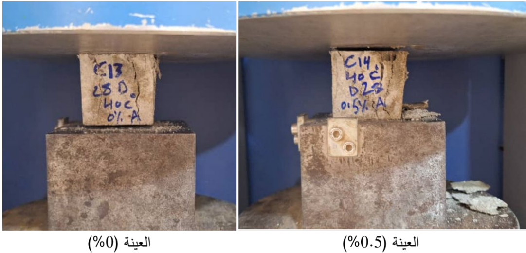
شكل (9) انهيار مكعبات المونة الأسمنتية عند 40 م 0
